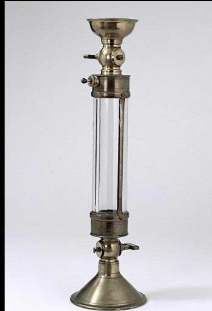
L'eudiomètre à eau en 1790
